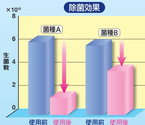
評価方法 ステンレス板に汚れ(ウシ血清アルブミン1.5%)と菌を混合した液を0.01mL塗布し、洗浄剤20倍希釈液を液体の形態で塗布、25℃5分間静置し、使用前後で評価菌の菌数変化を測定した。(洗剤・石けん校正取引協議会の「住居用合成洗剤及び石けんの除菌活性試験方法」に準拠。)(2018年12月、花王調べ) ※すべての菌を除菌するわけではありません。
