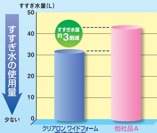
評価方法 40cm×90cmの排水溝のある洗浄装置槽に洗浄剤20倍希釈液を泡状噴霧装置で15秒間噴射後、流速15L/分の水(水温25℃)ですすぎ、泡が消失するまでの時間を測定、水量を算出した。
